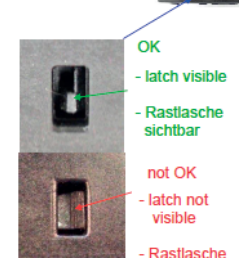
Fig. 34: 58-way module, visual check points Abb. 34: Modul 58-polig, Sicht Kontrollpunkte
